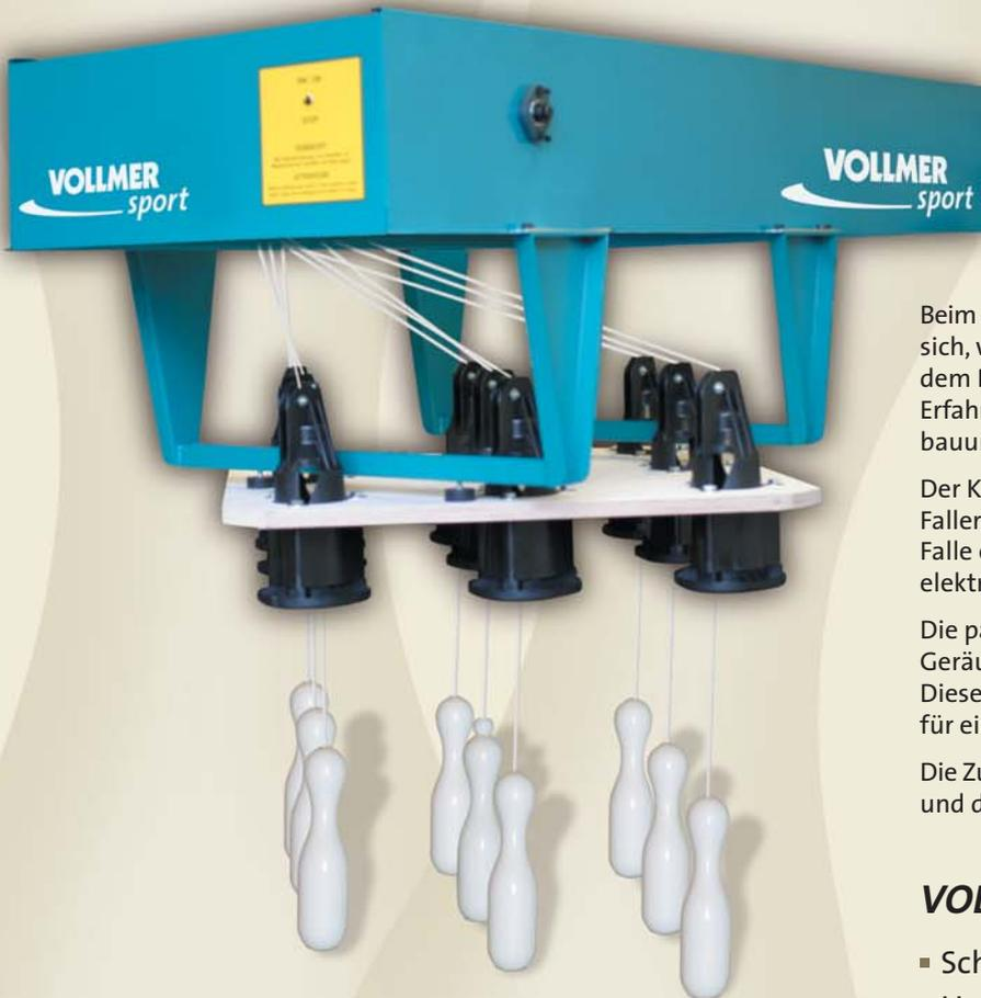
VOLLMER Sport Kegelstellautomaten werden eingesetzt auf Classic-, Scheren- und Bohlebahnen. In modifizierter Form auch auf Bowlingbahnen.
